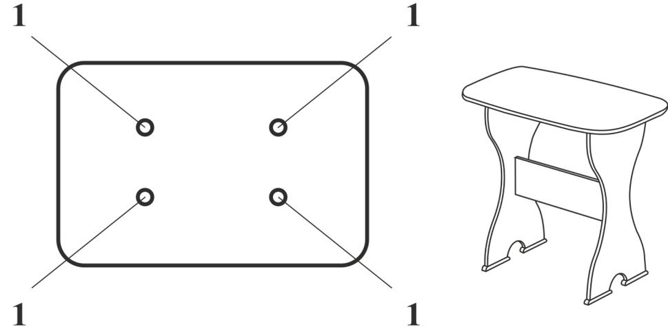
Крепление к столу производится с помощью мебельного уголка и винта (6\*10) в отверстия с бобышками (1).
