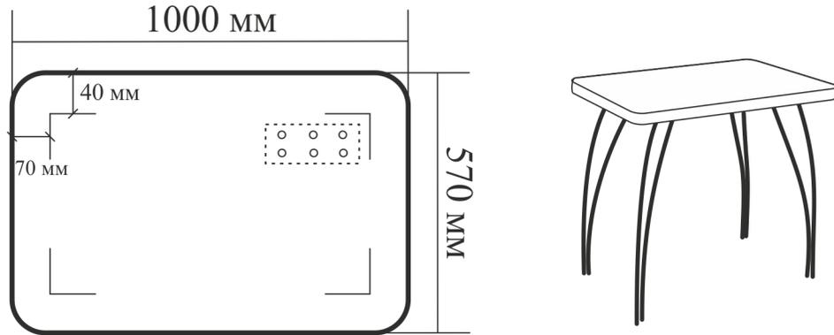
Крепление ног к столешнице производится саморезами (3,5\*19), с внутренней стороны столешницы, по угловым линиям, нанесенным карандашом. Если разметка отсутствует, то нужно произвести ее самостоятельно. Для этого нужно отложить от краев расстояние: 70 мм и 40 мм, согласно схеме. Далее следует очертить углы и крепить ноги.
