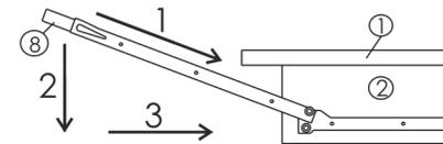
1.5. Установите выкатную полку №8 на направляющие, закрепленные на боковых стенках №2 и №3.
