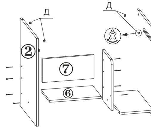
1.3. Соединить полученную тумбу и левую боковую стенку №2 с помощью полки №6, ограничителя №7.
