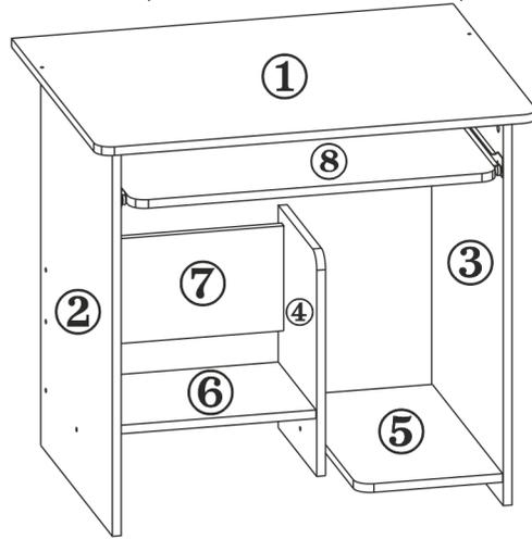
1.1. Закрепить на боковые торцы выкатной полки №8 ответные планки направляющих (В-2) с помощью шурупов 3,5x16 роликами назад.
