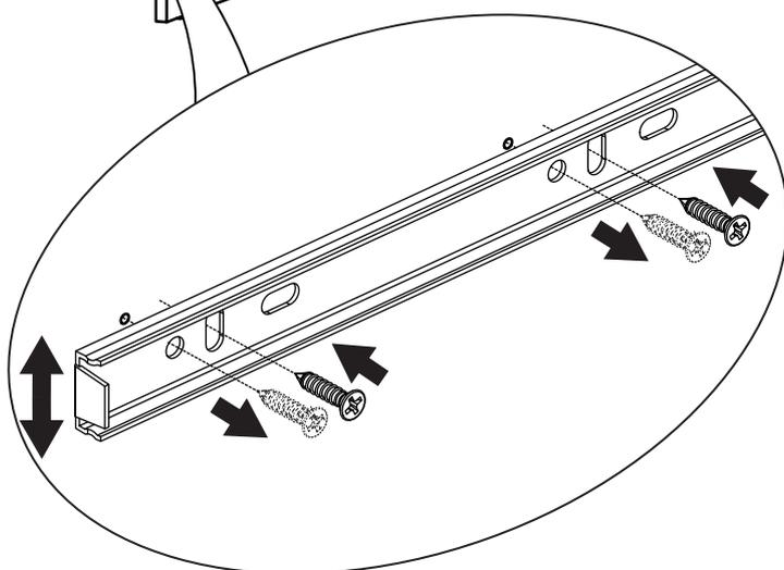
Если после установки ящиков зазоры между ними распределяются неравномерно - выдвиньте ящики, выкрутите 2 первых самореза (от лицевой стороны) и отрегулируйте зазор.
