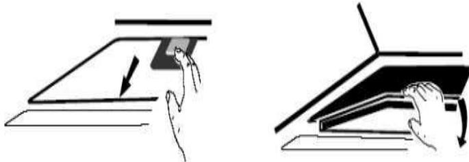
Установите угольный фильтр на моторе и поверните по часовой стрелке для закрепления.
